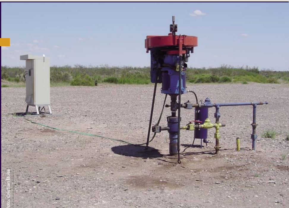
Pozo surgente, en el cual el petróleo surge espontáneamente, impulsado por el gas del reservorio.
