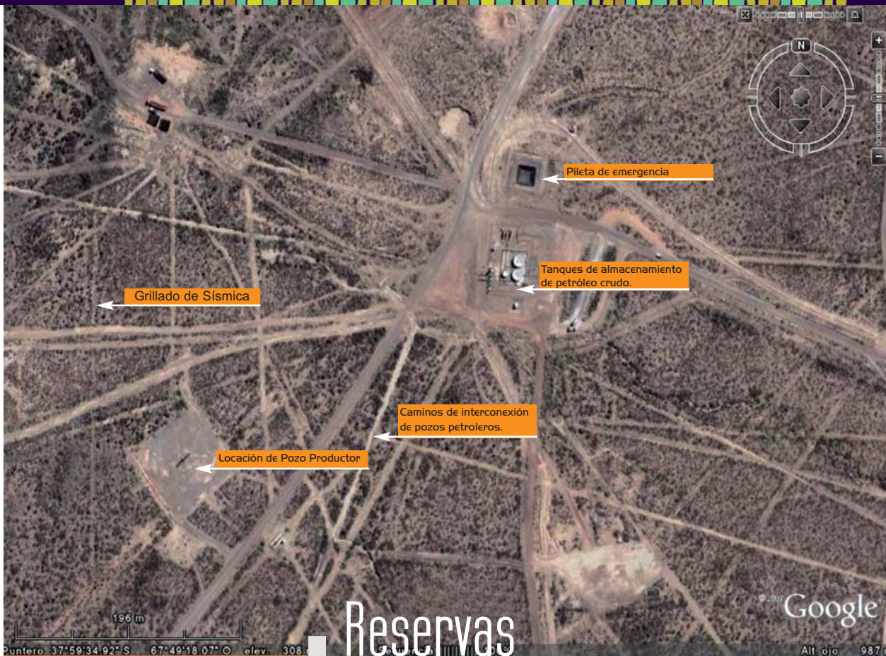
Vista satelital de una porción del Área Petrolera ubicada en la zona de 25 de Mayo - La Pampa- Argentina.
