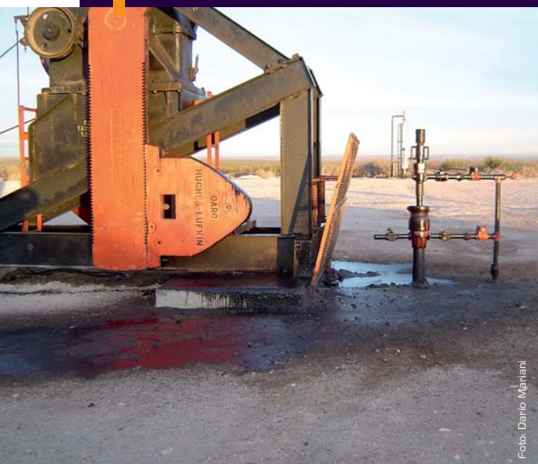
Derrame en puente de producción de un pozo petrolero.
